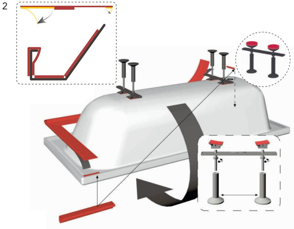
Wanne umkehren, Schürzenprofil anbringen, Schürzenstücke setzen, beide Doppelfüsse mit Quersteg montieren, Breite auf der Wanne anpassen und mit den Kontermuttern fixieren. Anschliessend Doppelfüsse aufkleben.
