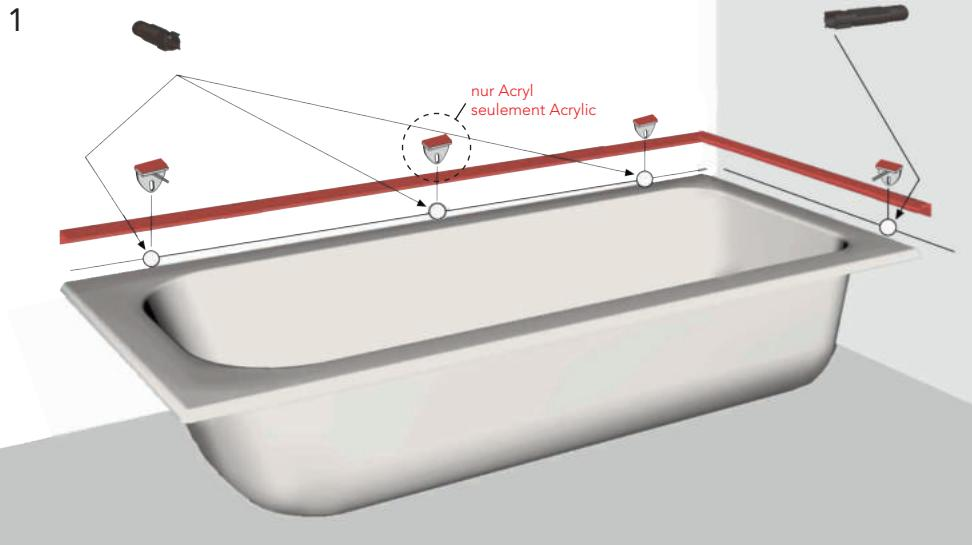
Wannenleiste an der Wand montieren. Wannenrandprofil aufkleben, die schmale Seite mit dem breiten Klebestreifen seitlich auf den Wannenrand kleben, die breitere Seite umklappen und auf die Wannenoberseite kleben.
