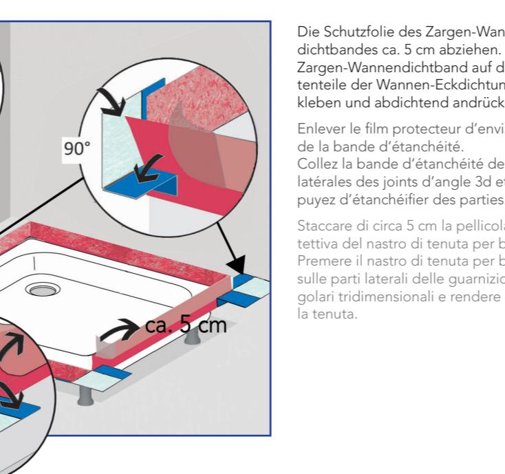
Die Schutzfolie des Zargen-Wannendichtbandes ca. 5 cm abziehen. Das Zargen-Wannendichtband auf die Seitensteile der Wannen-Eckdichtungen 3d kleben und abdichtend andrücken.
