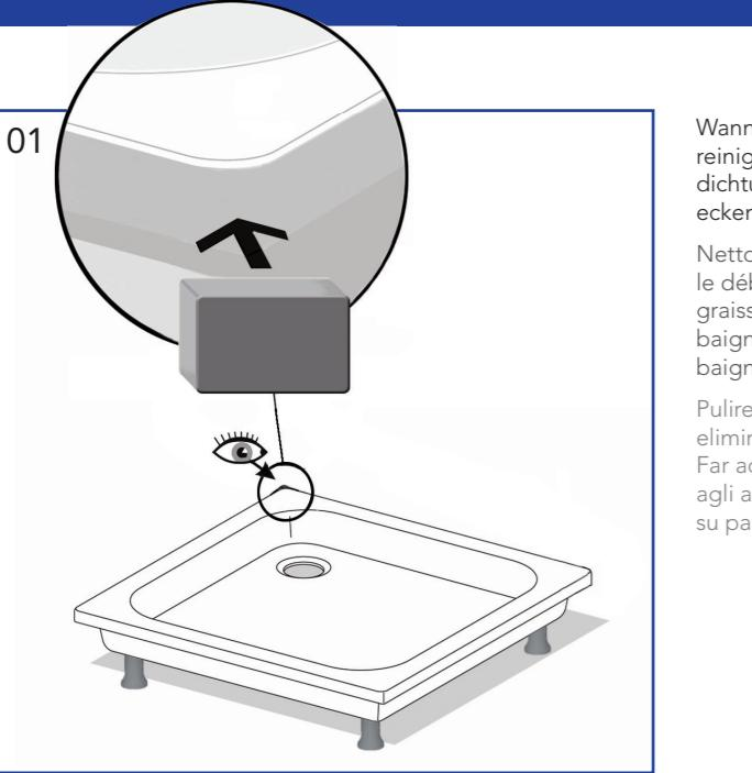
Wannenrand staub- und fettfrei reinigen. Die Wannen-Eckdichtungen auf die Wannenrandecken Wand/Wand kleben.
