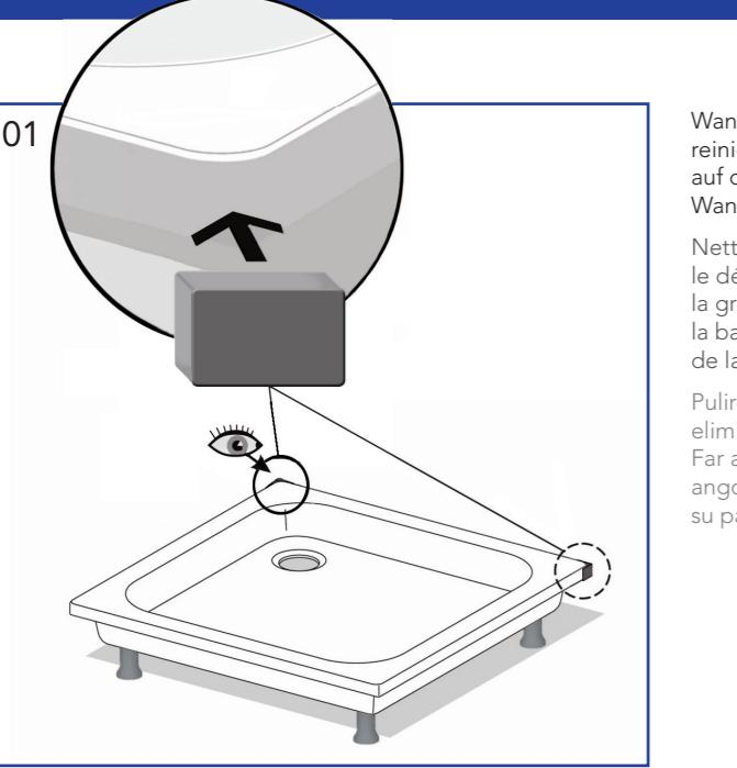
Wannenrand staub- und fettfrei reinigen. Die Wannen-Eckdichtungen auf die Wannenranddecken Wand/Wand kleben.
