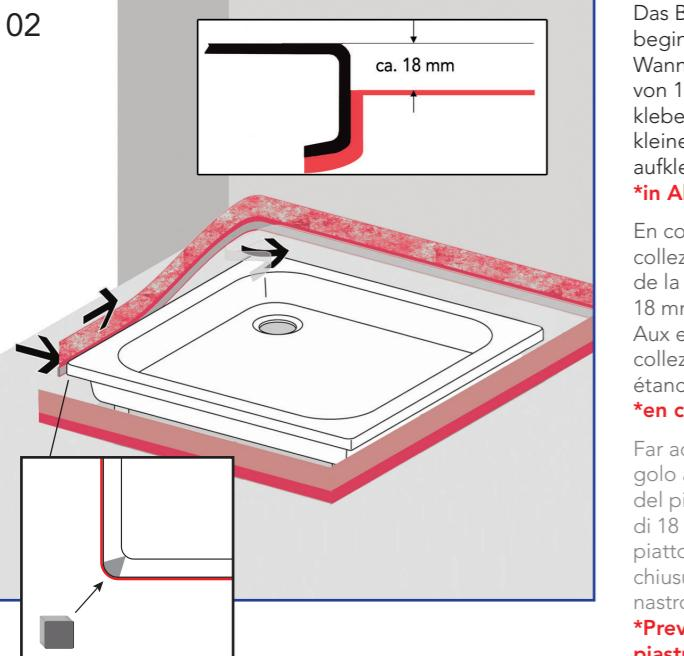
Das Band an der vorderen Ecke beginnend uumlafend an den Wannenrand mit einem Abstand von 18 mm\* zur Wannenoberfläche kleben. Bei den Bandenden das kleine Butylabschlussstück abdichtend aufkleben.
