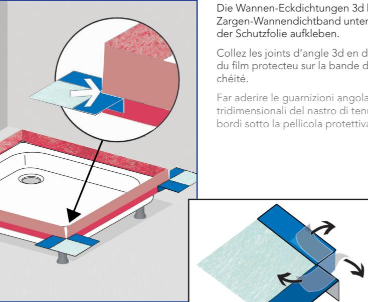
Die Wannen-Eckdichtungen 3d beim Zargen-Wannendichtband unterhalb der Schutzfolie aufkleben.
