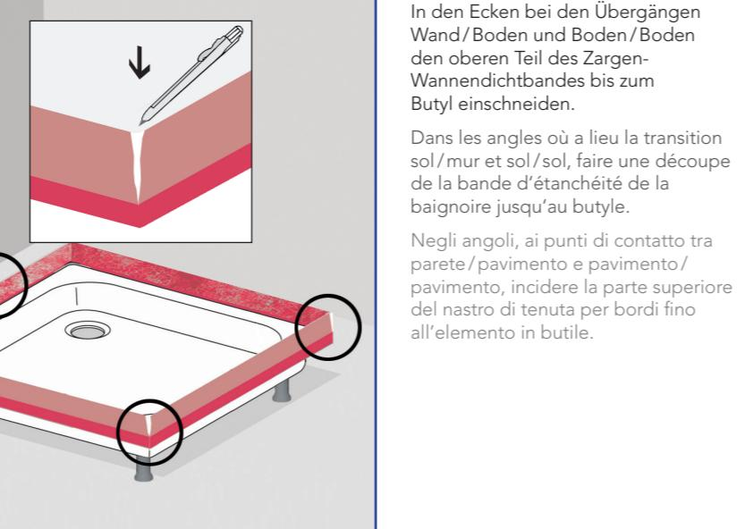
In den Ecken bei den Übergängen Wand/Boden und Boden/Boden den oberen Teil des Zargen-Wannendichtbandes bis zum Butyl einschneiden.
